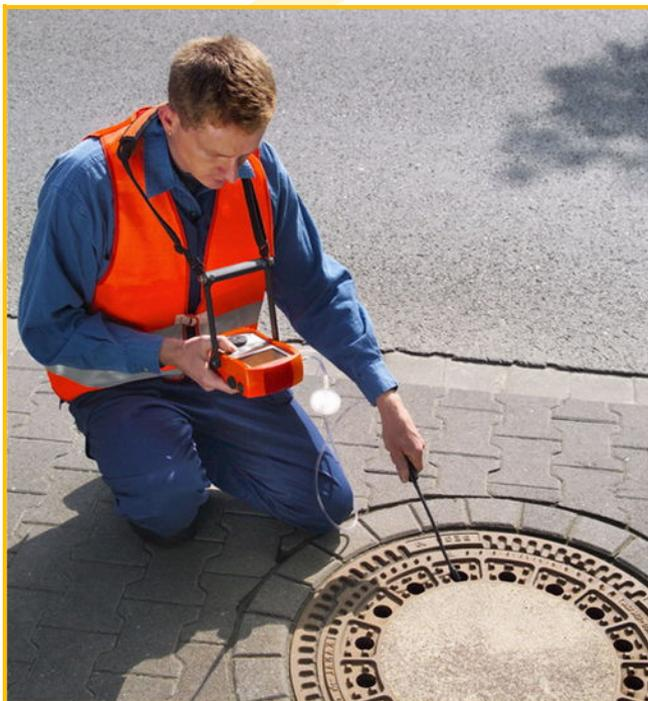
Questa nuova linea di apparecchi antideflagranti della Sewerin fornisce alle aziende di distribuzione del gas un unico e semplice strumento di lavoro per quasi tutte le attività inerenti la rilevazione, la ricerca e la localizzazione delle fughe di gas (con funzione esplosimetro, segnalazione carenza d'ossigeno e allarme gas tossici).
